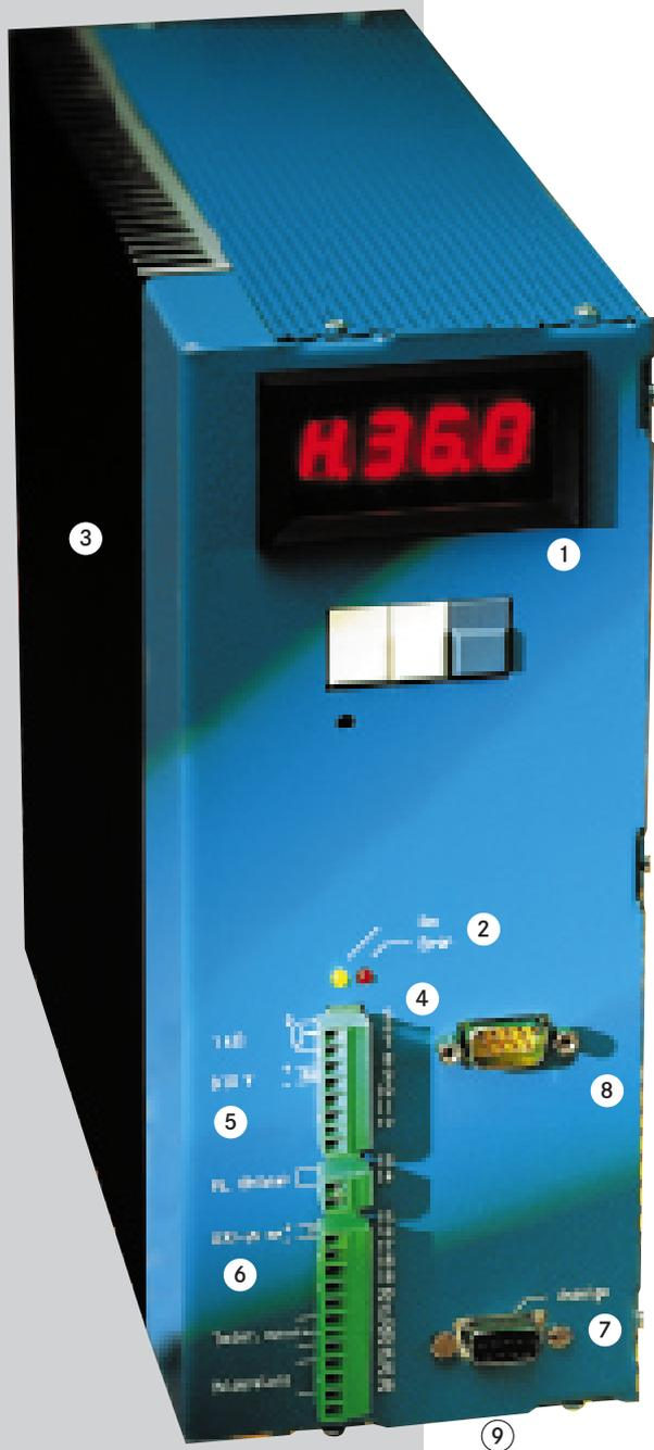
Der modulare Aufbau und das zukunftsorientierte Bus-Konzept der Digitalsteuerungen Vibtronic® SD machen die Fernbedienung und Fernabfrage von Soll- und Ist-Werten genauso einfach wie die Fehlerdiagnose und Wartungsfunktion von einer zentralen Leitwarte aus.
