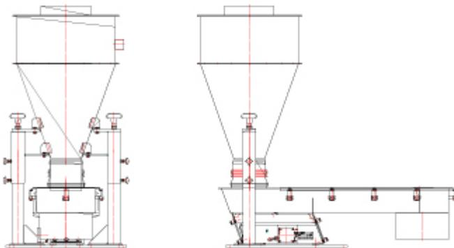
**Leistung (t/h):** 1 | **Schüttgut:** PUR-Abfall | **Schüttdichte (t/m<sup>3</sup>):** 0,6 | **Korngröße (mm):** 0-10
