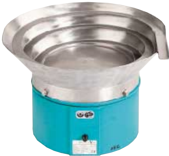
Teileförderer mit Kegeltopf ohne Schikaneneinbauten (Ordnungselemente)
