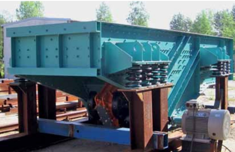
3 Grobabscheider für Tunnelbruch • Coarse separator for material excavated from a tunnel
